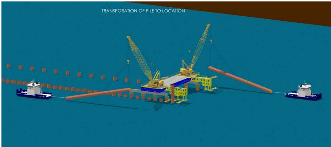
그림 1. Cantitravel System을 이용한 복합 벽강관식 안벽 공사 모식도
